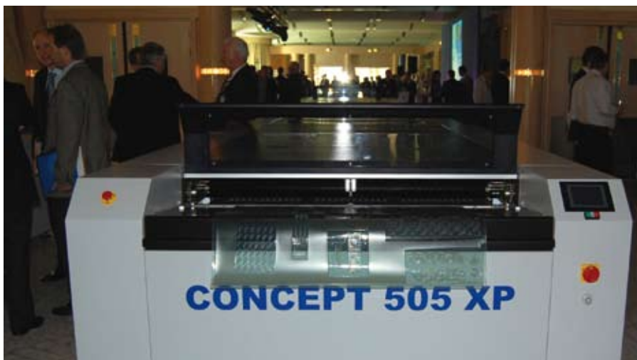
Concept 505 XP ist der weltweit erste Prozessor, der Flexodruckplatten sowohl im Stapel- als auch im Inline-Verfahren auswaschen kann.
